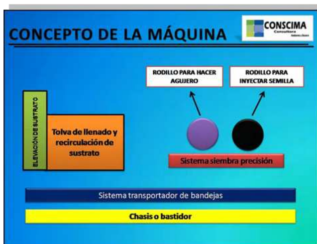
Gráfico 1. Esquema de las partes operativas de la máquina
