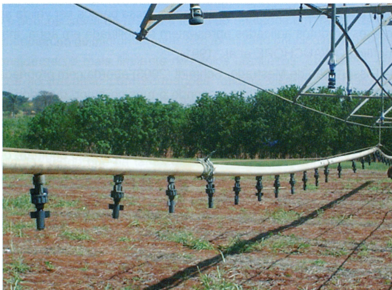
Figura 16 - Sistema de barra acoplada ao pivô
