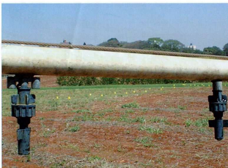
Figura 17 - Em detalhe, exemplificação dos bicos do sistema de barra acoplada
