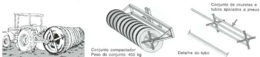
Figura 9 - Desenho do implemento montado. Detalhes da confecção nas figuras 9.1, 9.2 e 9.3. Desenhos: Naterra Sementes (1999)
