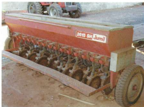
Figura 14 - Detalhe da semeadora de 14 linhas, semi-nova e mais barata para a aquisição (vista pela parte traseira), que distribui de forma conhecida as sementes que irão formar as altas populações de planta, e que devem ser de alta qualidade: critério fundamental à implantação de sistemas intensivos, principalmente
