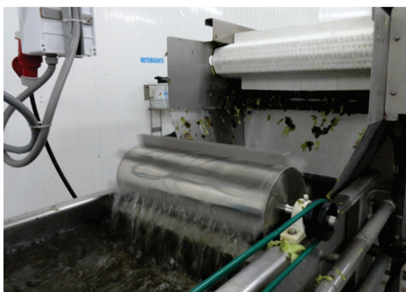
Figura 15 - Lavagem de hortaliça folhosa com sistema de tambor rotativo
