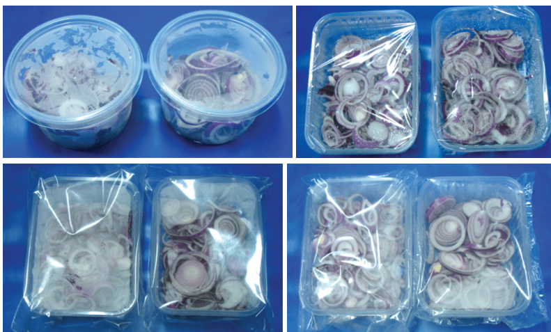
Figura 12 - Cebolas minimamente processada acondicionada em diferentes embalagens. (a) recipiente de polipropileno (PP); (b) filme de policloreto de vinila (PVC); (c) filme de PP; (d) filme de polietileno de baixa densidade (PEBD)
