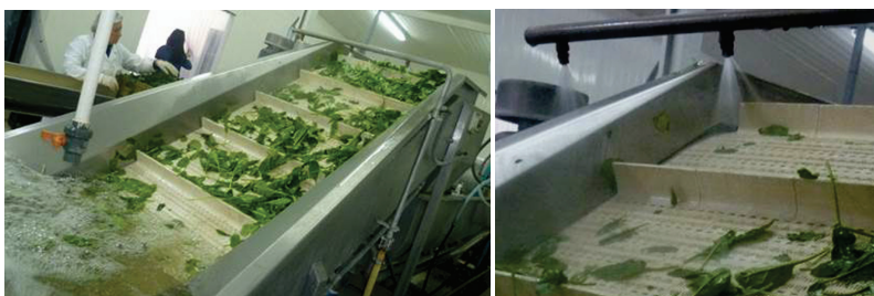
Figura 9 - Etapas de sanitização (a) e detalhe da sanitização por aspersão (b)
