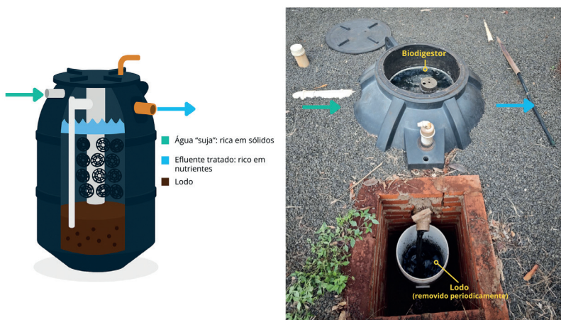
Figura 4 –Esquema de funcionamento do biodigestor utilizado para mineralização dos resíduos sólidos do sistema de aquaponia do Setor de Piscicultura da ESALQ – USP
