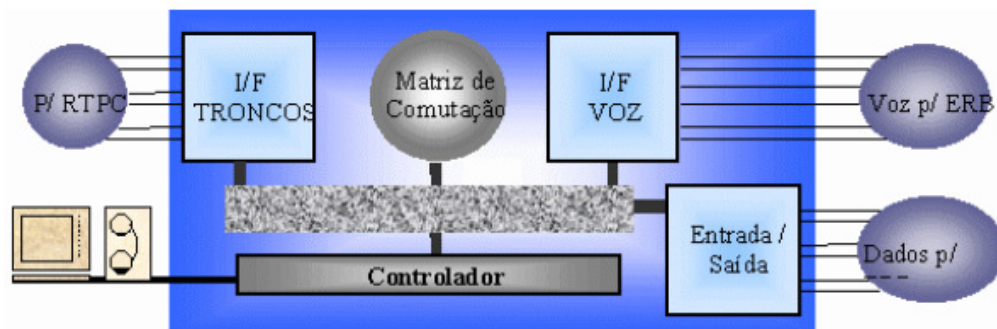
Central de Comutação e Controle - CCC. Fonte: Wikipedia
