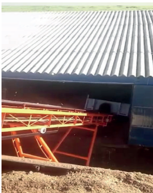
Figura 7. Momento em que está sendo feita a condução da cama usada do interior do galpão, até o caminhão, utilizando-se a esteira transportadora.
