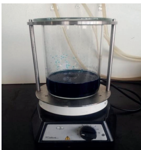
Figura 3. Aparato experimental para o processo de adsorção AM pela CA.
