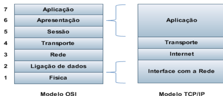
Figura 14: A diferença entre modelo OSI e TCP/IP
