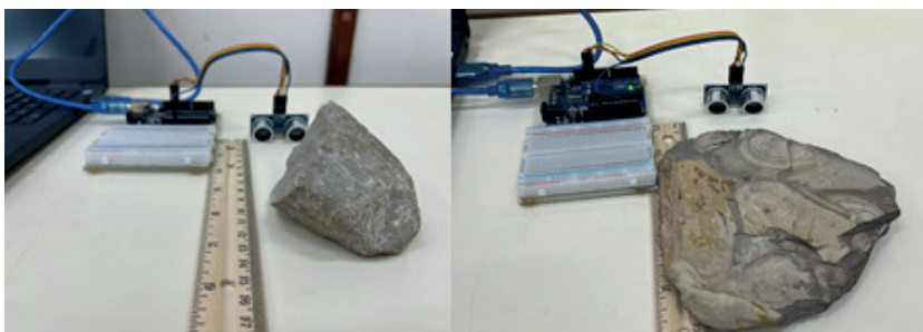
Figura 2 - Teste nas rochas como sensor ultrassônico.
