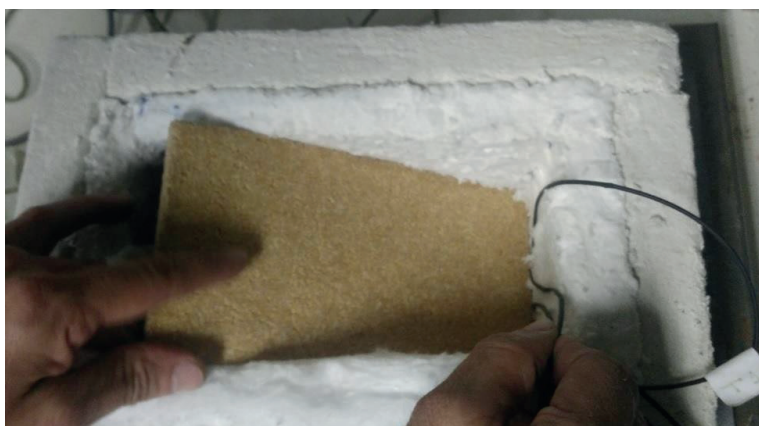
Figura 09. Instalação da placa no condutímetro
