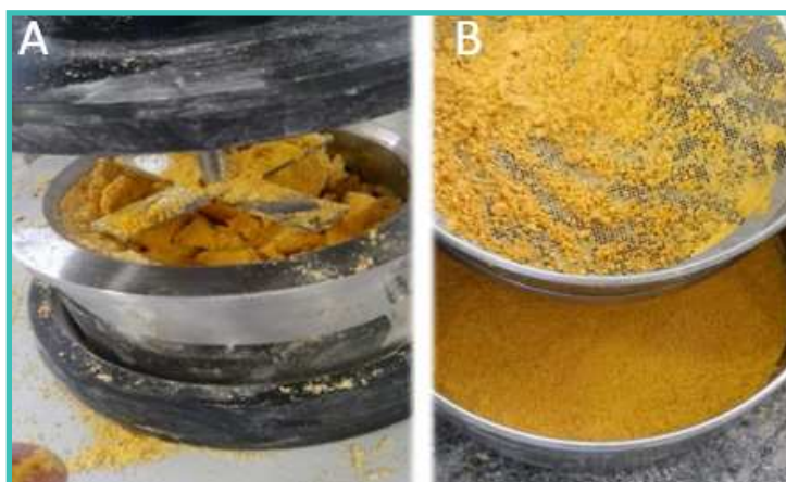
Figura 4. (A) Moagem do mesocarpo da pupunha; (B) Peneiramento da farinha de mesocarpo de pupunha
