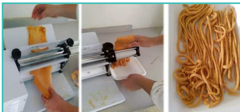
Figura 9. Processamento da massa alimentícia de pupunha (MP)
