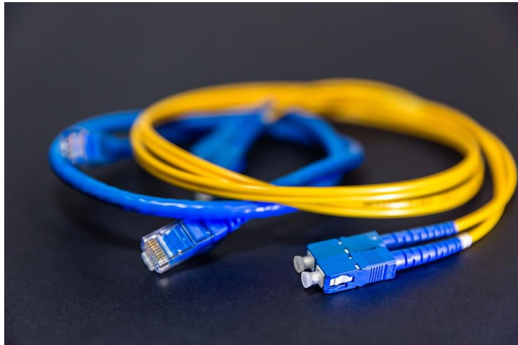
Figura 6. Cabo Ethernet (esquerda-azul) e fibra óptica (direita-amarela)
