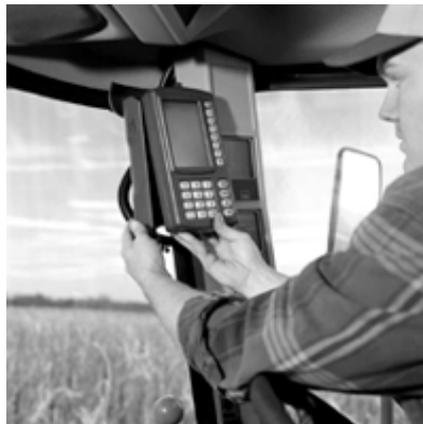
Figura 5.11 - Sistema de monitorização da produtividade (Fonte: [www.deere.com](http://www.deere.com))
