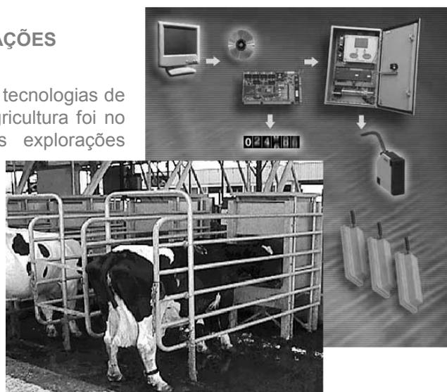
Figura 2.1 Sistema de alimentação individual automático 5
