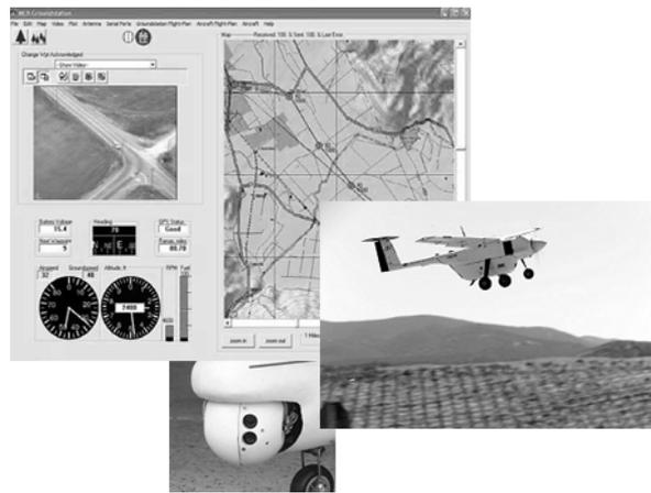
Figura 7.6 – UAV voando sobre campo agrícola, interface de controlo remoto e pormenor dos dispositivos de captura de imagem (Fonte: <http://www.skyplanes.com> e <http://www.uav-applications.org>)
