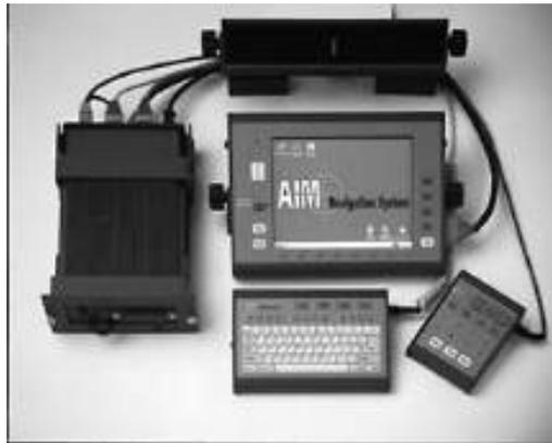
Figura 5.14 - Sistema de navegação com GPS, GIS e controlador VRT (Fonte: <http://www.caseih.com>)
