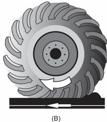
Figura 3.22. Cisalhamento do solo: (A) na mobilização e desagregação, representada pela ação de uma aiveca; camadas do solo deslizam umas sobre as outras devido à ação da ferramenta (adaptado de MIALHE, 1967). A tração sobre um solo (B): a força exercida pelo pneu provoca o deslizamento relativo de uma placa de solo, sob a área de contato.
