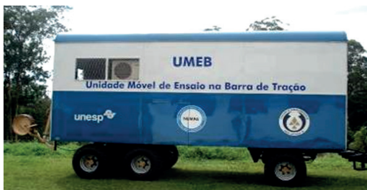
Figura 2. Unidade dinamométrica para aplicação de cargas controladas em ensaios de desempenho na barra de tração. NEMPA/Botucatu 2018.
