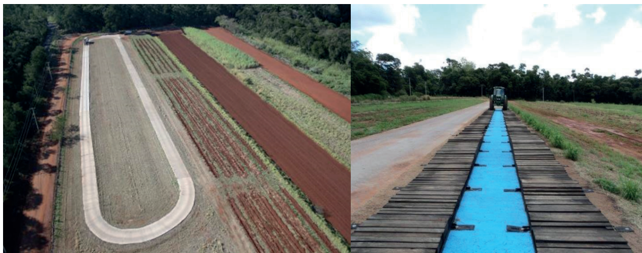
Figura 4. Pistas padronizadas para ensaios de tratores agrícolas, da esquerda para direita: pista oval de concreto; pista de solo mobilizado; pista de solo em preparo convencional; pista de solo em sistema de plantio direto, pista de solo firme e pista de vibração de tratores.
