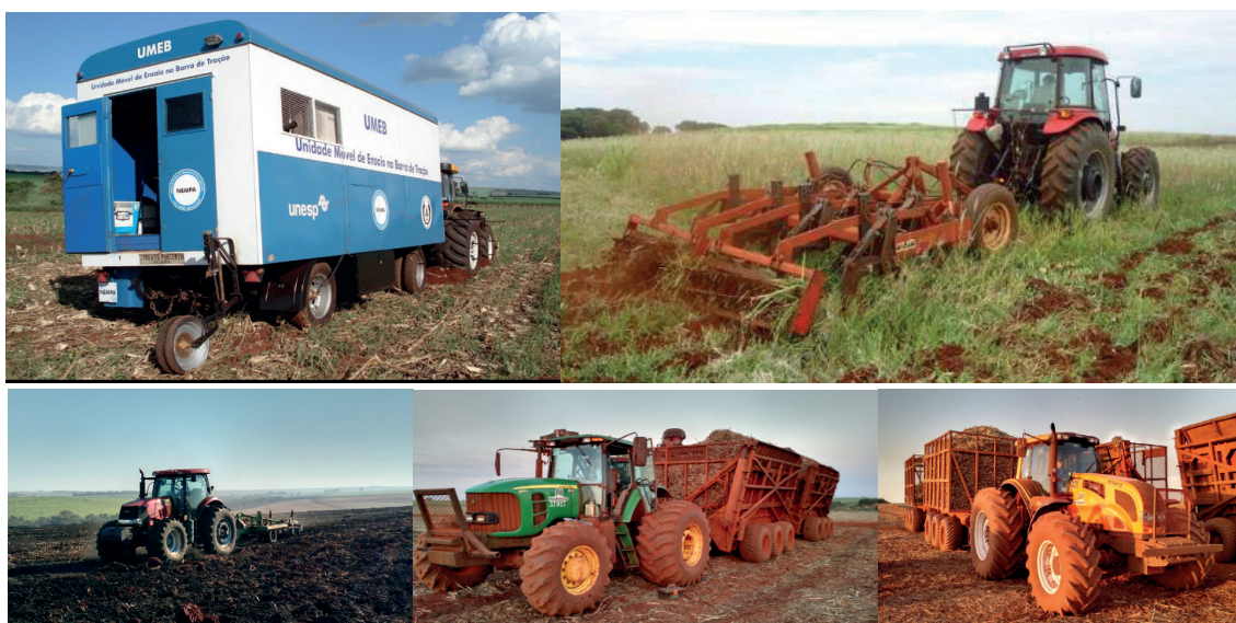
Figura 3. Ensaios de campo avaliando desempenho de tratores, com carro dinamométrico (esquerda) e com subsolador (direita). NEMPA/Botucatu 2018.
