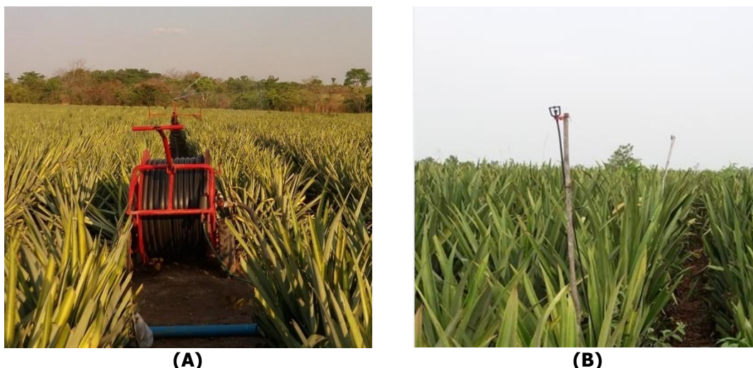
Figura 1. (A) Mini autopropelido sendo utilizado na irrigação do abacaxizeiro, e (B) Haste de elevação do emissor em uma área irrigada de abacaxizeiro com sistema de microaspersão.
