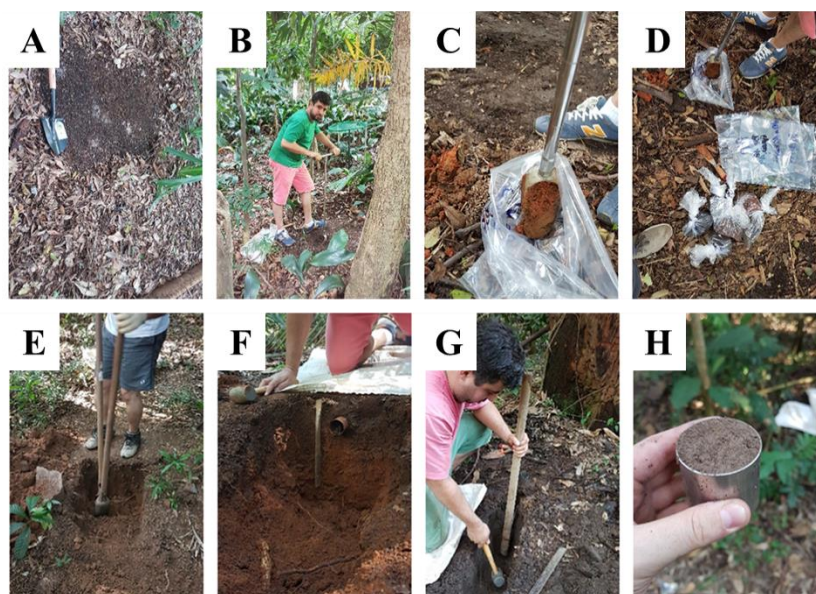
Figura 3. Etapas de abertura de trincheira e coleta de solos.
