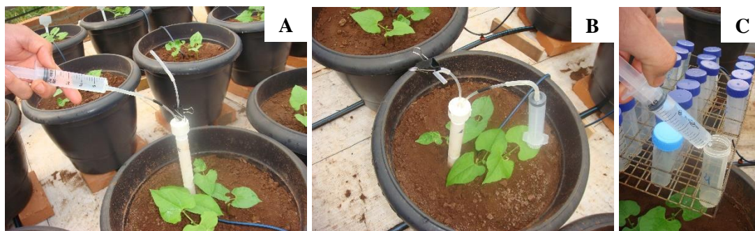
Figura 2. Extração de solução do solo. A) Vácuo aplicado. B e C) Armazenamento da solução.
