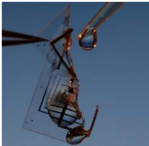
Figura 7. Circuitos electrónicos biodegradáveis já funcionam como curativos electrónicos, mas logo poderão se dissolver no corpo humano. [Imagem: Fiorenzoomenetto/Tufts University]
