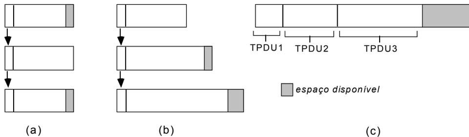
**Figura 2.3.5.6** - As diferentes soluções de armazenamento: (a) buffers de tamanhos iguais; (b) buffers de tamanhos variáveis; (c) buffer circular.
