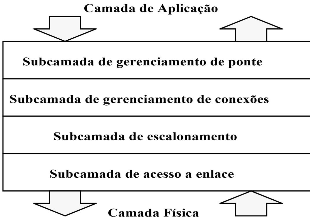
**Figura 4.9** - A camada de Enlace do SP-50
