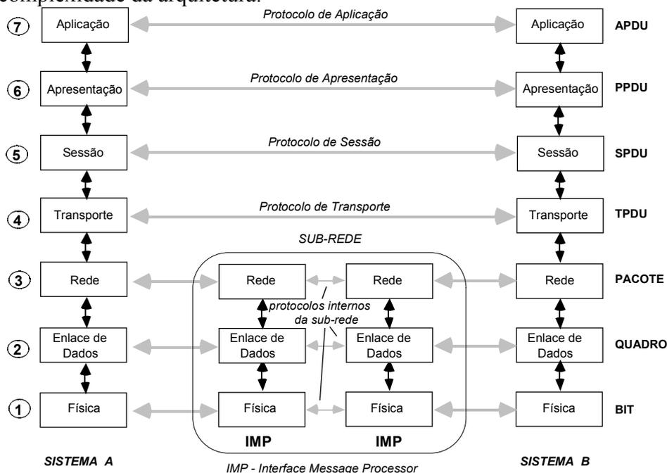
**Figura 2.2.1** - Arquitetura a sete camadas do modelo OSI.
