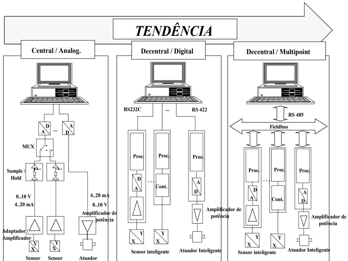
**Figura 4.1 - Tendências na interligação de sensores / atuadores**
