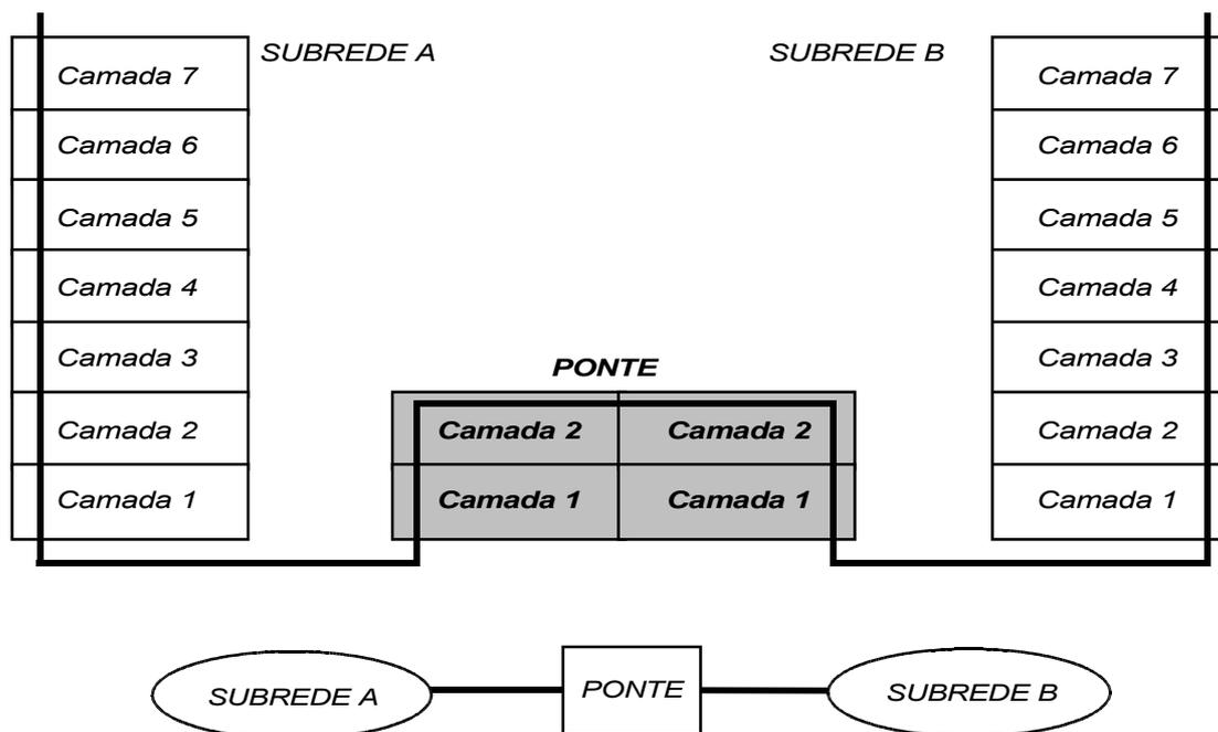
**Figura 2.4.6** - Ponte interconectando duas sub-redes (nível OSI 2).
