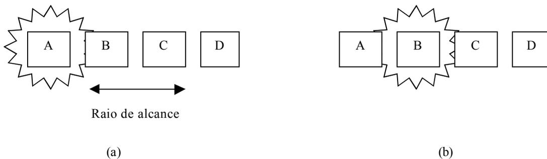
**Figura 2.27** - (a) estação A transmitindo; (b) estação B transmitindo
