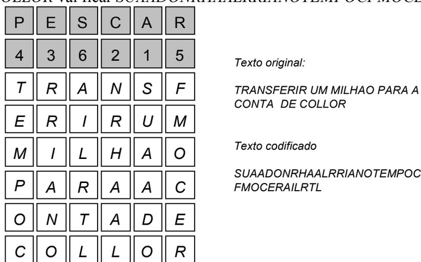
**Figura 2.3.52** - Exemplo da transposição por colunas.
