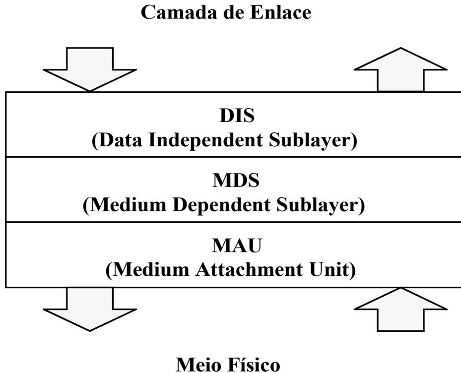
**Figura 4.7 - A camada física do SP-50**
