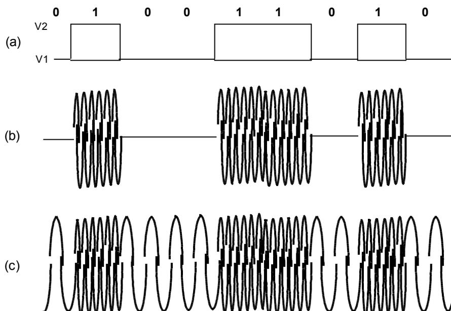
**Figura 2.3.5** - (a) Sinal digital; (b) Sinal modulado em amplitude (ASK); (c) Sinal modulado em frequência (FSK).
