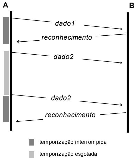
**Figura 2.3.3.11** - Protocolo considerando controle de erro por quadro de reconhecimento com temporização.
