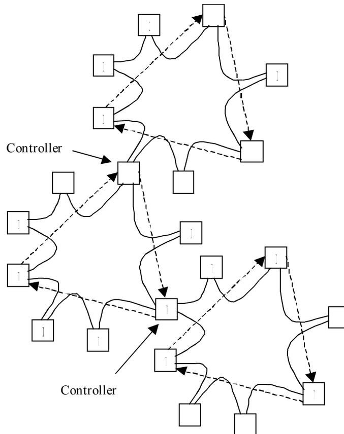
**Figura 5.12** - Vários anéis P-NET interligados por Controllers
