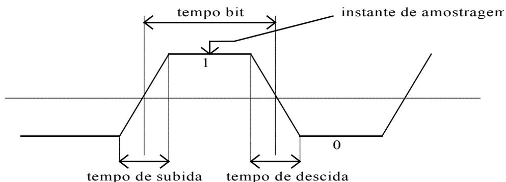
**Figura 2.3.6** - Tempo bit e amostragem de sinal
