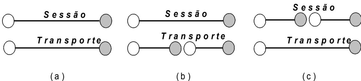
**Figura 2.3.44** - Diferentes relações entre conexão de Sessão e de Transporte: (a) correspondência 1 a 1; (b) várias conexões de Transporte para uma única *sessão*; (c) uma conexão de Transporte para várias *sessões*.
