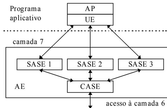
**Figura 2.3.8.2** - Os elementos da camada de aplicação
