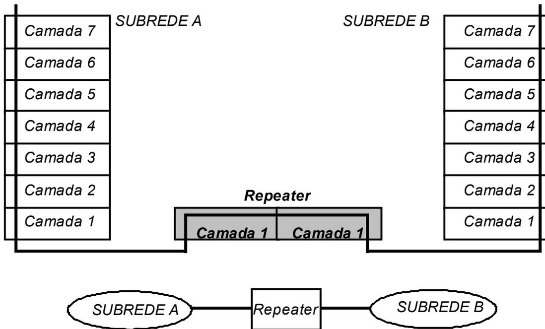
Figura 2.4.4 - Repetidor expandindo uma rede (nível OSI 1)
