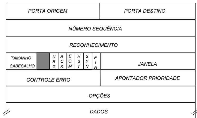
**Figura 2.3.5.10** - Formato do cabeçalho da TPDU do TCP.
