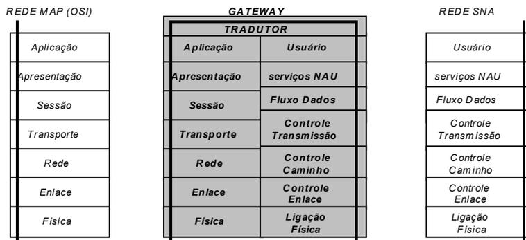
**Figura 2.4.8 - Interconexão baseada em gateway.**
