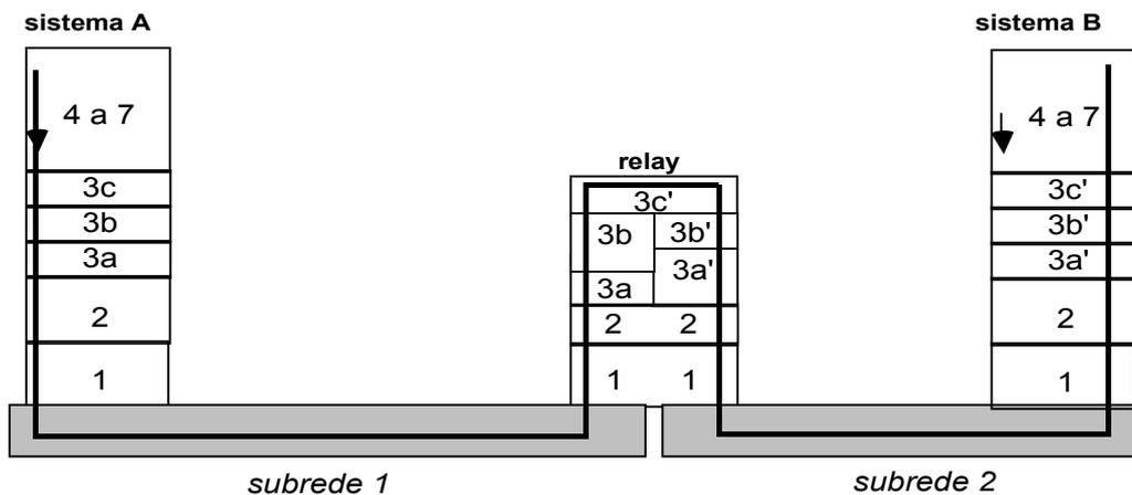
**Figura 2.4.2** - Estrutura interna da camada de rede do ponto de vista da interconexão, segundo o modelo OSI.
