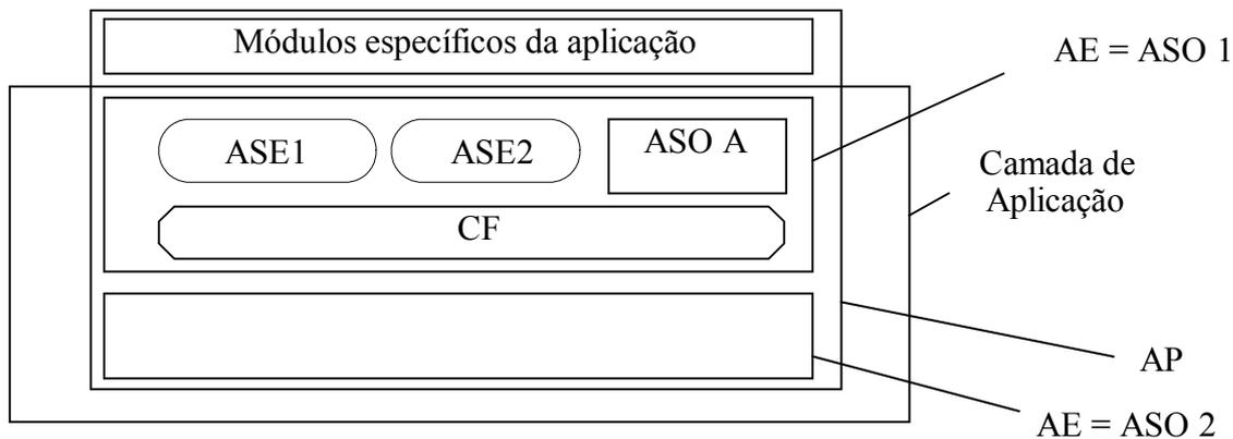
**Figura 2.3.8.1** - Conceitos da camada de aplicação
