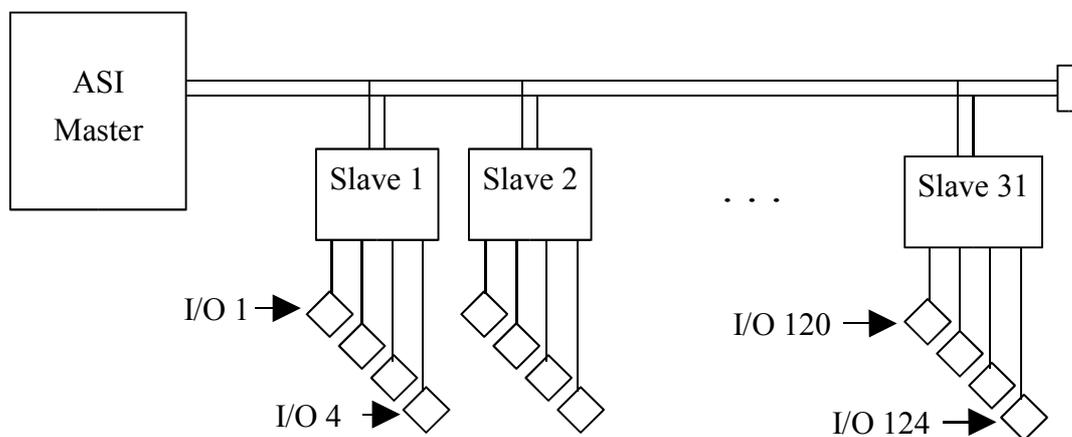
**Figura 5.7** - Configuração típica de um segmento ASI
