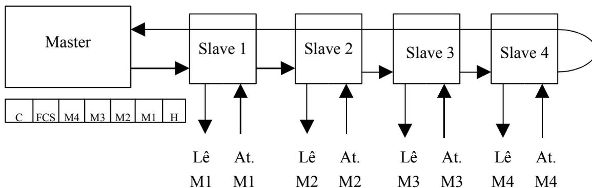
**Figura 5.4** - Varredura dos escravos no INTERBUS-S
