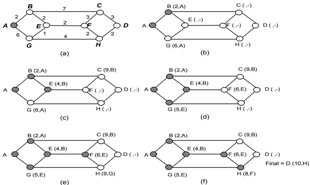
**Figura 2.3.27** - Ilustração do algoritmo de Dijkstra.
