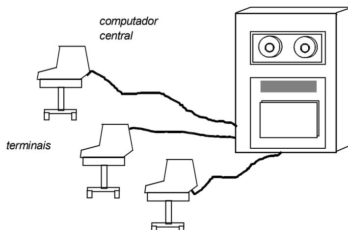
**Figura 2.1.4** - Configuração com vários terminais.
