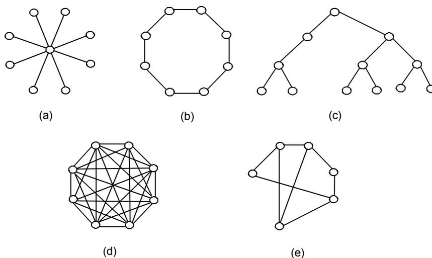
**Figura 2.1.1** - Topologias ponto-a-ponto: (a) estrela; (b) anel; (c) árvore; (d) malha regular; (e) malha irregular.
