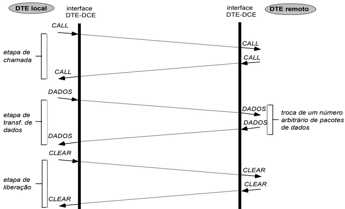
**Figura 2.3.30** - Comunicação entre dois DTEs via X.25.
