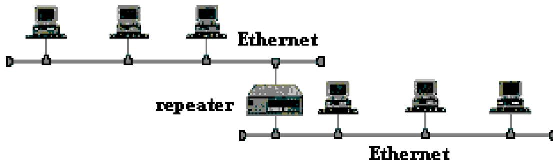
Figura 2.4.5 - Repetidor em redes CSMA/CD (Ethernet)
