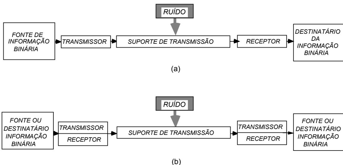
**Figura 2.3.4** - (a) Sistema de transmissão ponto-a-ponto unidirecional; (b) modelo bidirecional.
