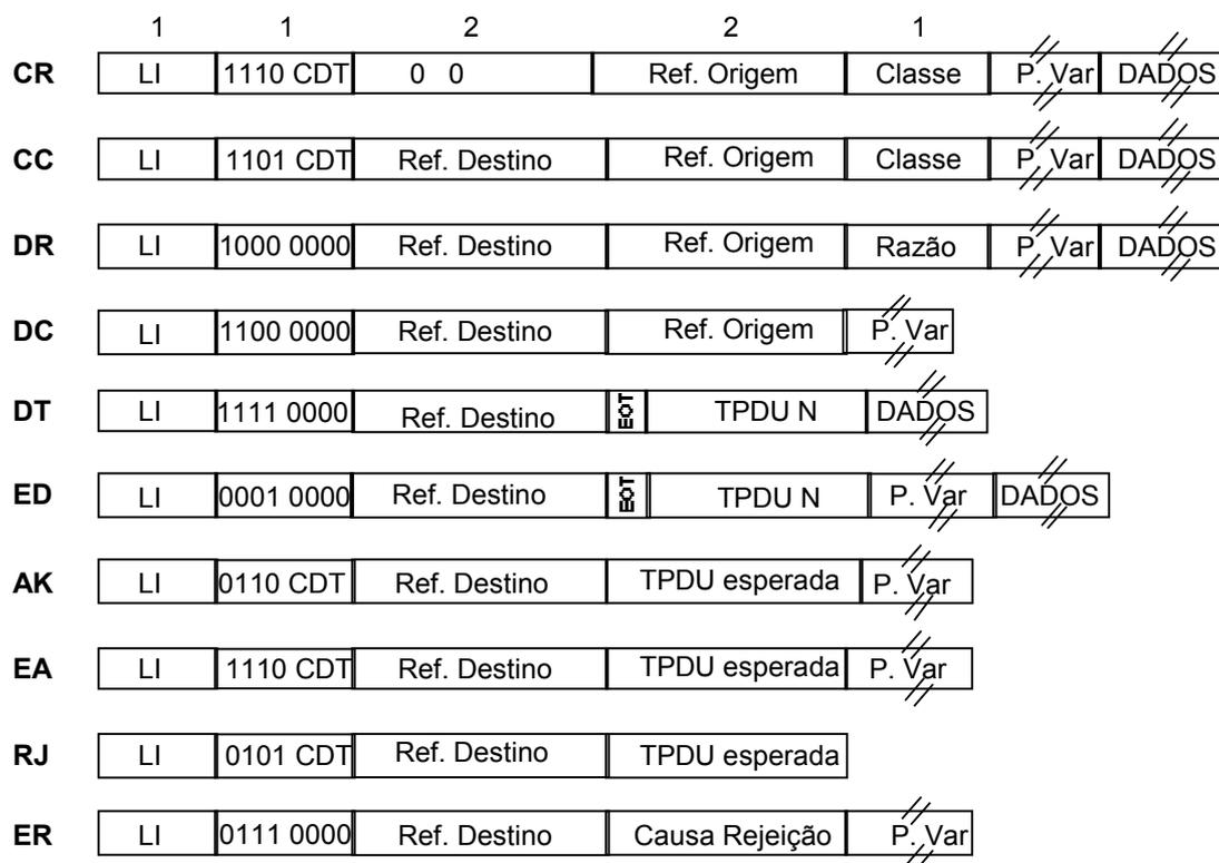
**Figura 2.3.5.8 - TPDU's do protocolo de Transporte OSI.**
