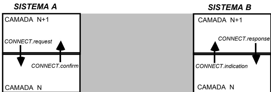
**Figura 2.2.4** - Ilustração da troca de primitivas de serviço (confirmado).
