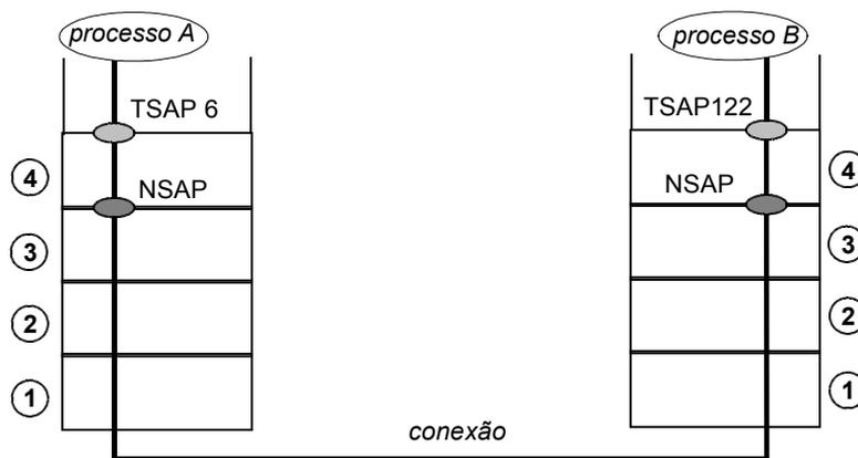
**Figura 2.3.5.2** - Relação entre TSAP, NSAP e conexão de Transporte.
