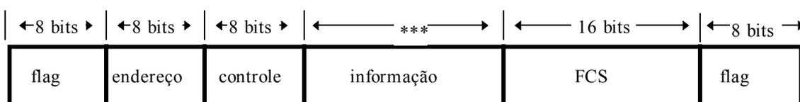
Figura 2.3.3.15 - Estrutura de um quadro HDLC.
