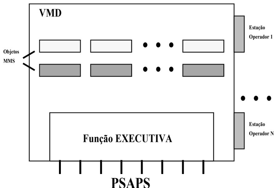
Figura 3.4 - Estrutura geral de um VMD
