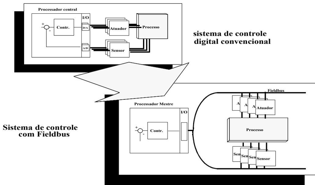
**Figura 4.3 - Malha Fechada de Controle com Fieldbus**
