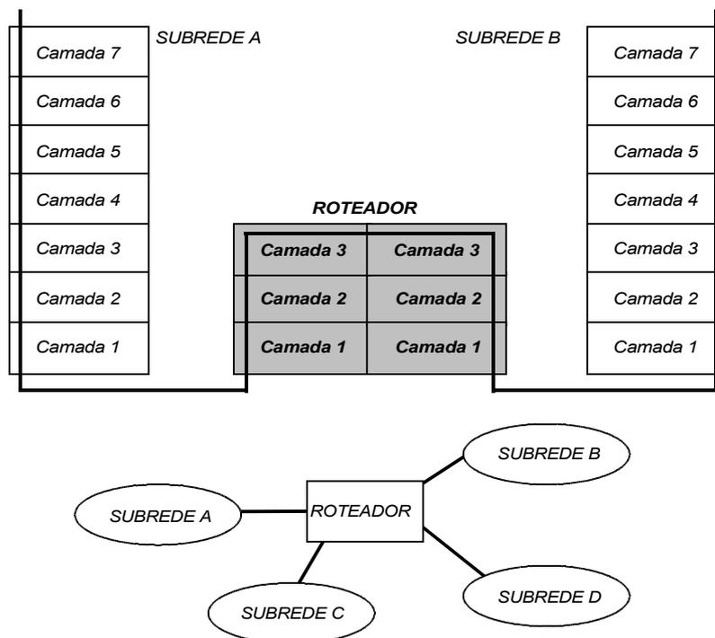
**Figura 2.4.7** - Roteador interligando subredes (nível OSI 3).
