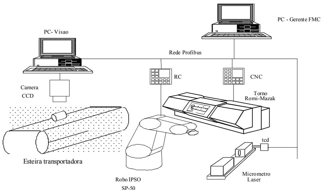
**Figura 5.3** - Aplicação típica da Rede SINEC L2-FMS
