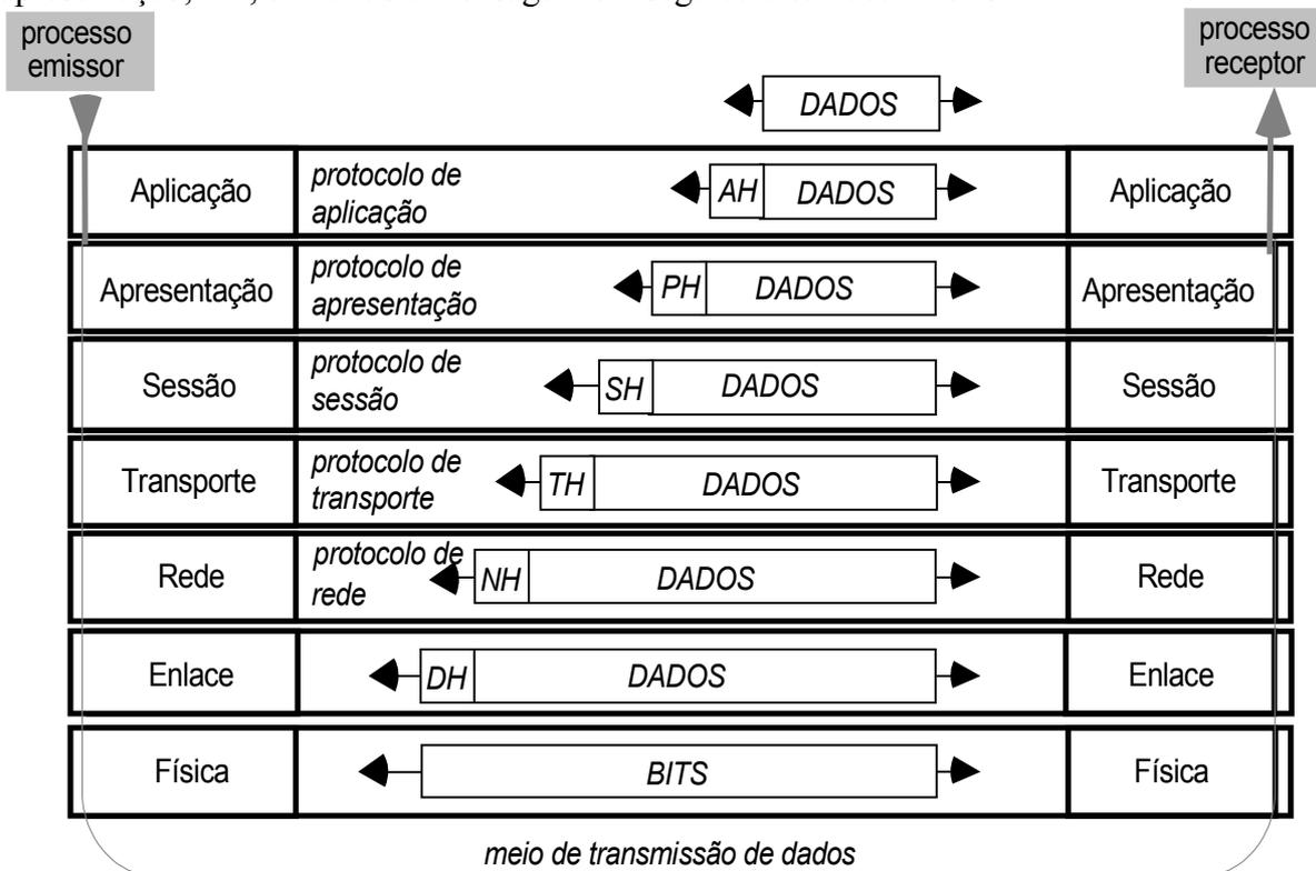
**Figura 2.2.2** - Ilustração da comunicação no modelo OSI.
