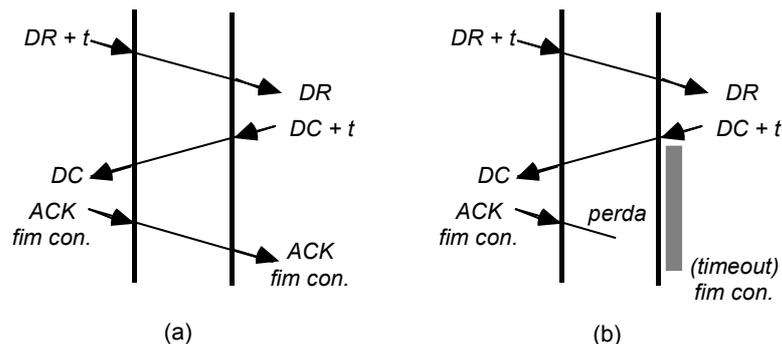
**Figura 2.3.5.5** - Liberação de conexão em três etapas: (a) caso normal; (b) caso de perda do reconhecimento.
