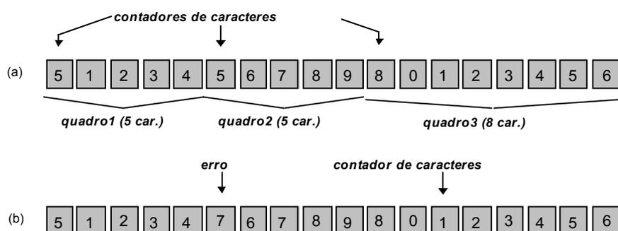
**Figura 2.3.3.5** - Seqüência de caracteres: (a) sem erro; (b) com erro.
