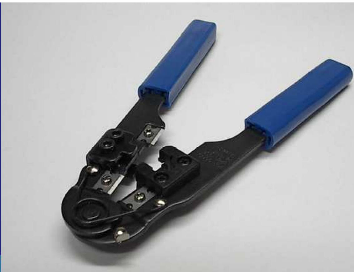
O alicate crimpador também é usado para cortar e desencapar os cabos UTP. As funções indicadas na figura ao lado são:
