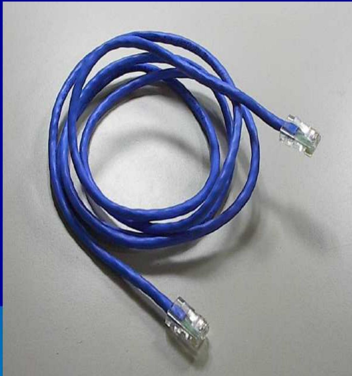
Os cabos de rede mais usados atualmente são os do tipo "par trançado" (UTP = unshielded twisted pair). Os conectores usados nesses cabos são chamados RJ-45. O cabo usa conectores RJ-45 tipo "macho", também chamado de PLUG RJ-45. Nas placas de rede encontramos um conector RJ-45 tipo "fêmea", também chamados de JACK RJ-45.
