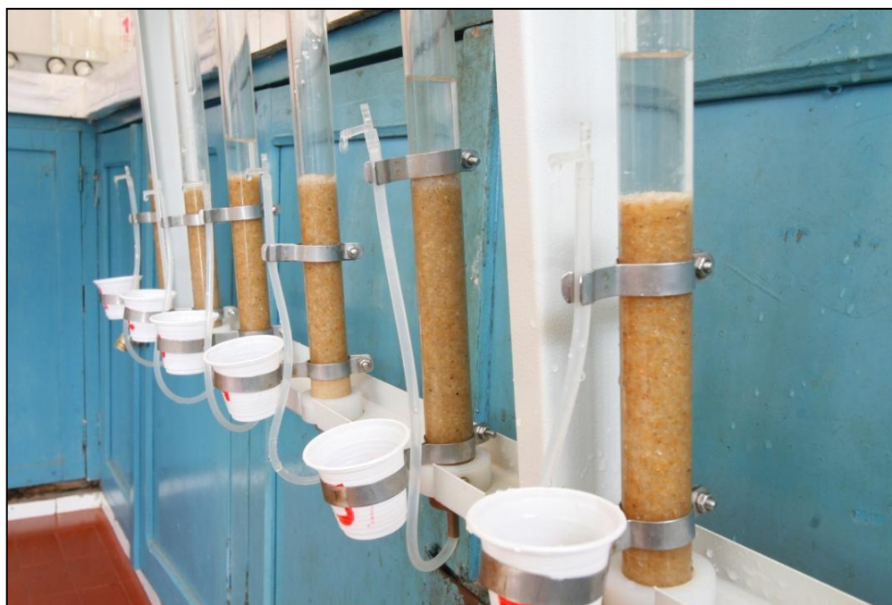
Figura 3.17 – Filtros de laboratório de areia e meio filtrante.
