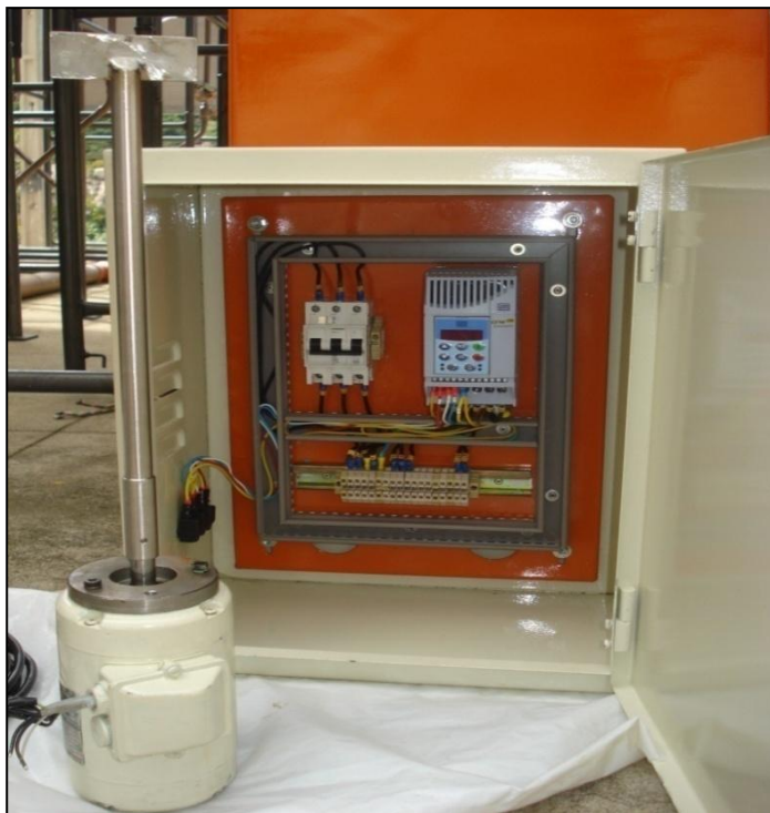
Figura 3.10 – Detalhe do motor elétrico, haste de mistura e quadro de comando com inversor de frequência do agitador mecânico (montagem própria).
