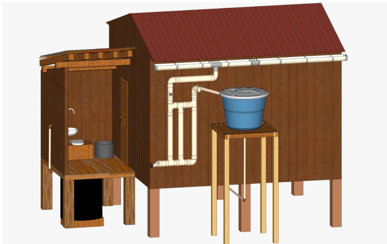
Figura 5 – Sistema de captação de água de chuva e banheiro ecológico ribeirinho, acoplados a uma residência ribeirinha.
