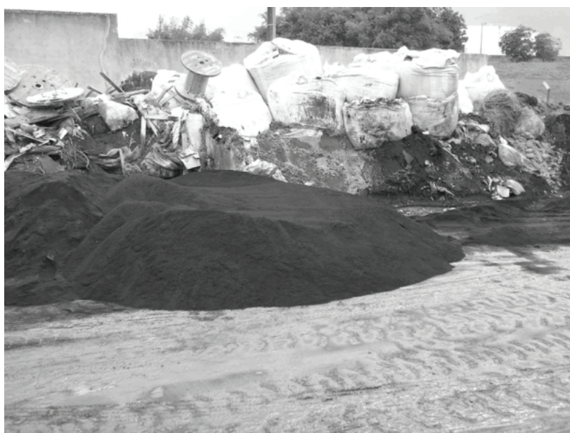
Figura 2 - Catalisador usado removido por varrição da área industrial e armazenado em local temporário da refinaria.
