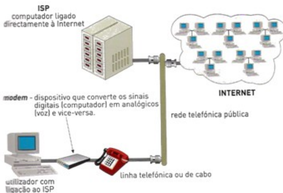
Ilustração 14: Esquema simplificado de ligação à Internet
